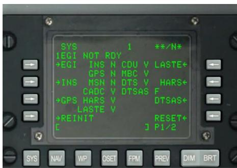
**Рис. 133. Система обозначения кнопок LSK.**
