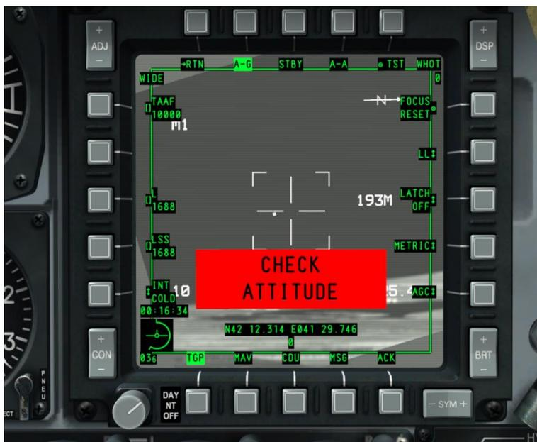
Рис. 251. Предупреждение системы TAAF в режиме A-G TGP.
