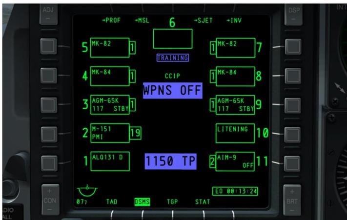
**Рис. 212. Активный профиль Weapons Off, главный переключатель вооружения в положении TRAIN.**
