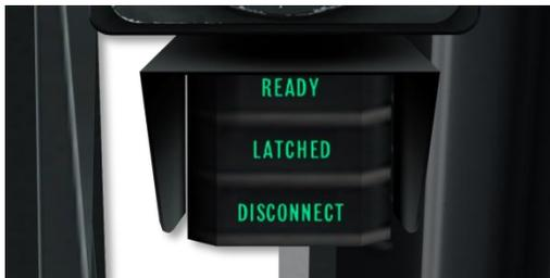
**Рис. 103. Табло системы дозаправки в воздухе.**
