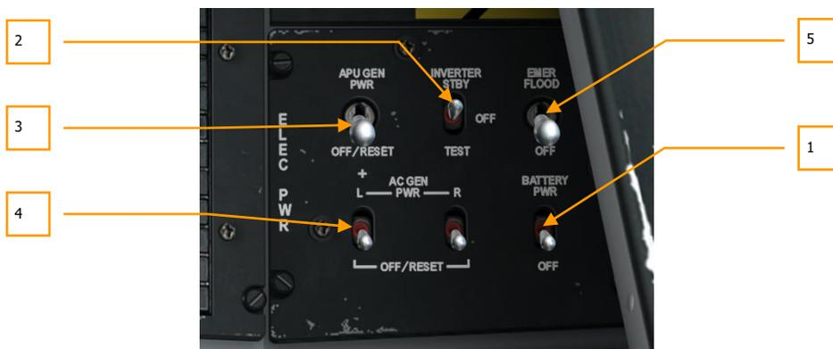
**Рис. 124. Панель управления электропитанием.**
