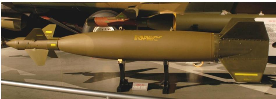
**Рис. 55. Управляемая бомба с лазерным наведением GBU-10.**
