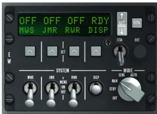
Рис. 290. Устройства отстрела ЛТЦ и ДО включены.
