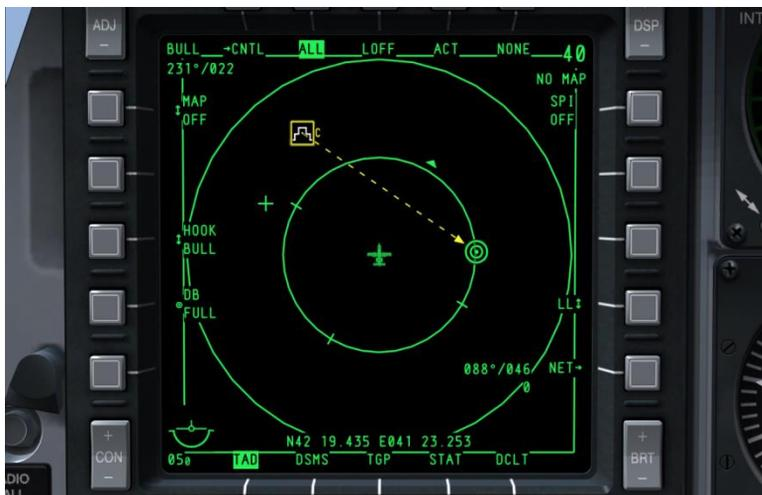
Рис. 229. Режим привязки BULL на TAD.
