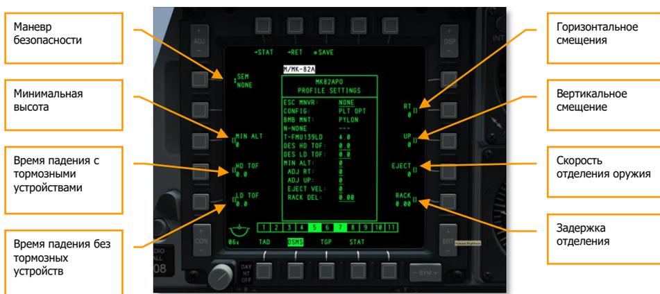
**Рис. 426. Настройка профиля DSMS, неуправляемые бомбы с тормозными устройствами.**
