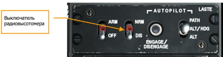
**Рис. 297. Панель LASTE.**
