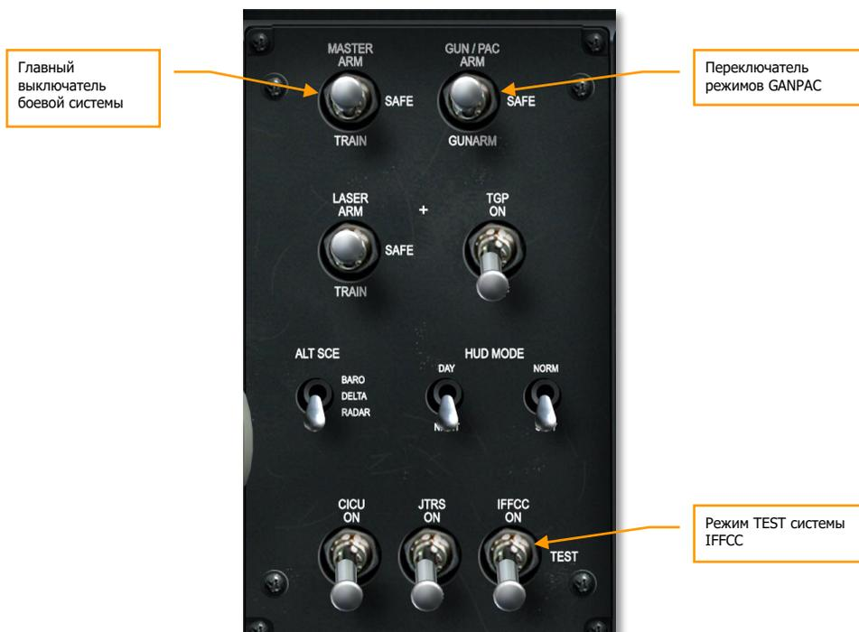
**Рис. 405. Панель системы управления вооружением (АНЦР).**
