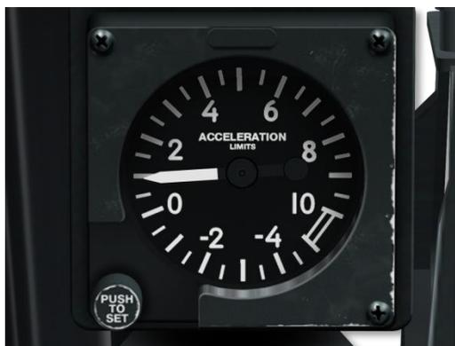
**Рис. 104. Указатель перегрузки.**
