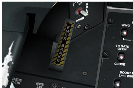
Рис. 115. Аварийный ручной тормоз.
