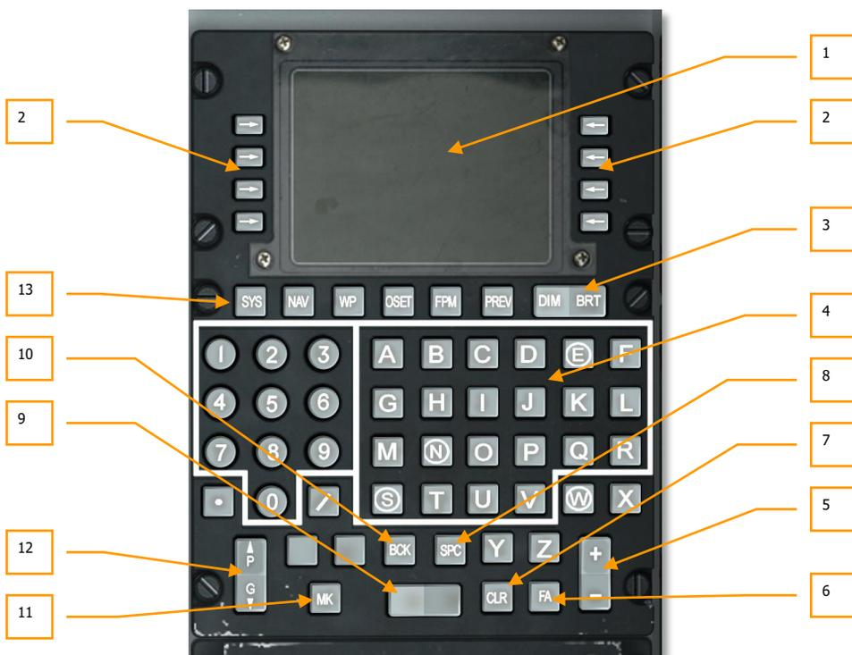
**Рис. 132. Блок управления и индикации (CDU).**
