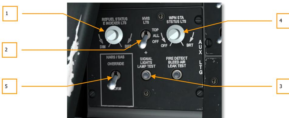
Рис. 116. Панель управления вспомогательным освещением.
