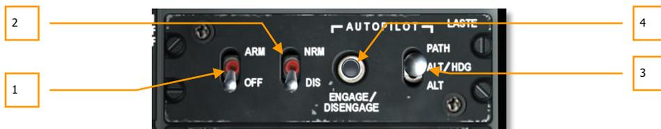
Рис. 109. Панель управления LASTE.
