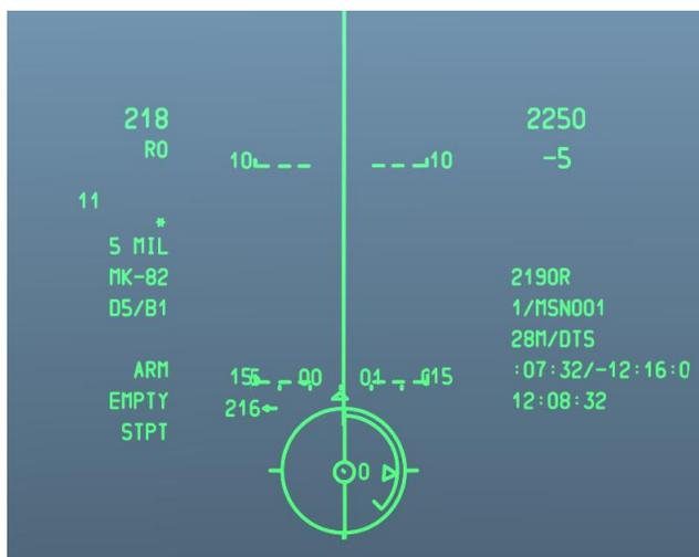
**Рис. 273. Момент сброса бомб в режиме ССIP CR.**
