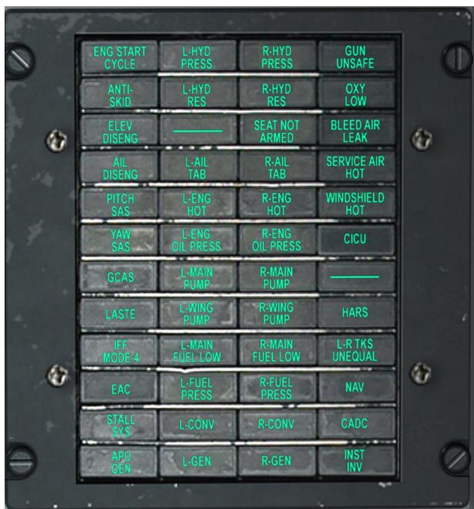
**Рис. 127. Панель табло предупредительной сигнализации.**
