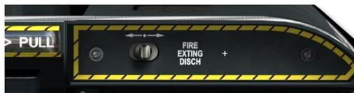
**Рис. 93. Переключатель системы пожаротушения.**
