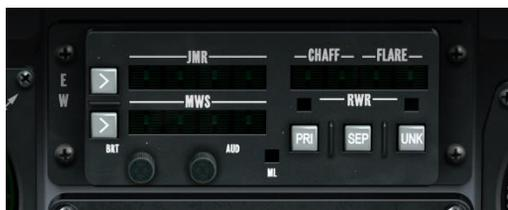
**Рис. 87. Щиток управления системой противодействия.**
