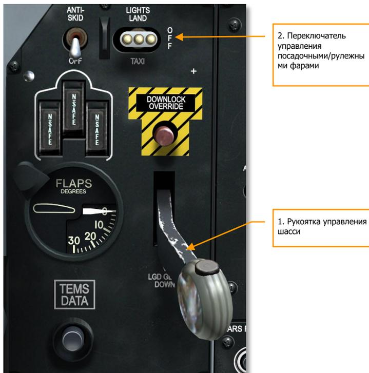
Рис. 302. Панель управления шасси и индикатор положения закрылков.
