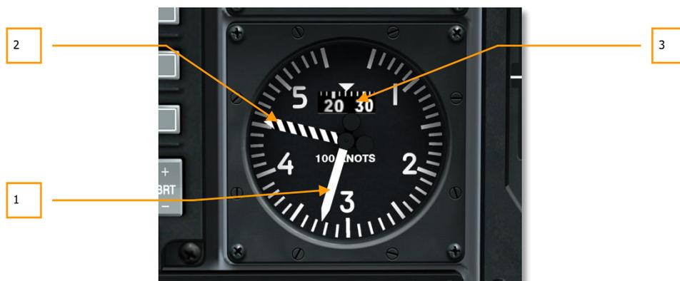
**Рис. 74. Указатель воздушной скорости.**
