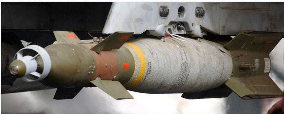
**Рис. 56. Управляемая бомба с лазерным наведением GBU-12.**
