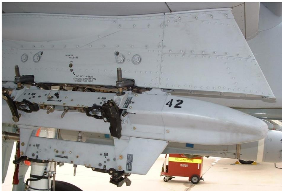
Рис. 43. Трёхзамковый балочный держатель BRU-42.
