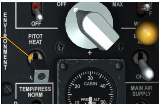
Выключатель подогрева трубки ПВД (PITOT HEAT)
