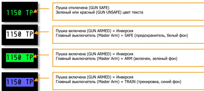
**Рис. 215. Индикация состояния пушки.**
