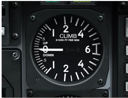
Рис. 98. Указатель вертикальной скорости.
