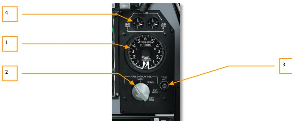
**Рис. 95. Панель топливомера и индикации состояния гидравлических систем.**
