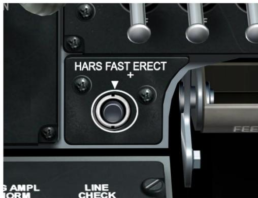
**Рис. 83. Кнопка быстрого выравнивания резервной курсовертикали.**
