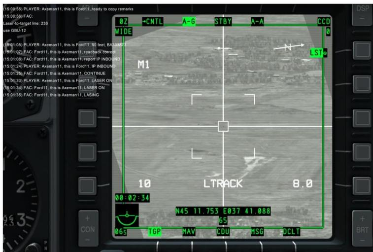
**Рис. 247. TGP в режиме сопровождения лазерного пятна.**
