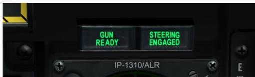
**Рис. 84. Табло готовности пушки и механизма разворота колеса.**
