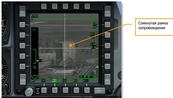
**Рис. 468. Ракета Maverick в корреляционном режиме.**
