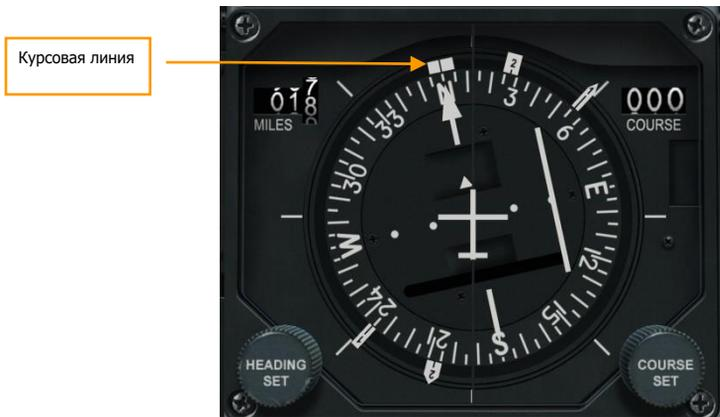
**Рис. 381.** Плановый навигационный прибор.
