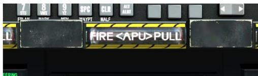
**Рис. 86. T-образная рукоятка тушения пожара ВСУ.**
