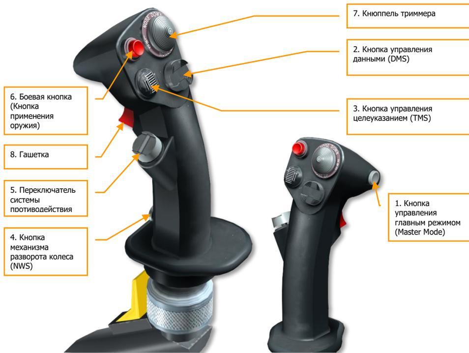
Рис. 69. Ручка управления самолетом.
