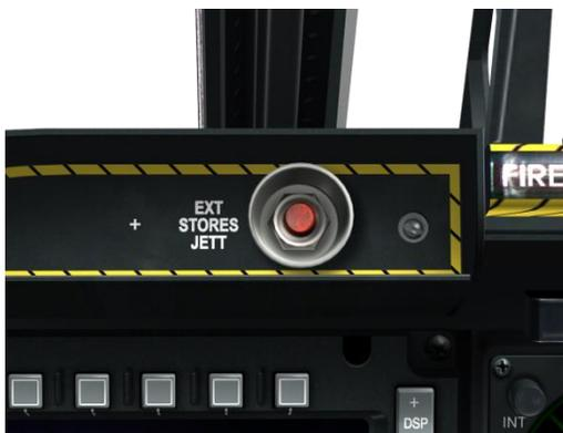
**Рис. 79.** Кнопка аварийного сброса подвесок.
