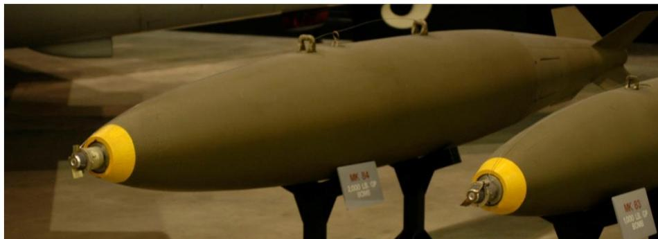
**Рис. 48. Авиабомба с низким коэффициентом сопротивления Mk-84.**
