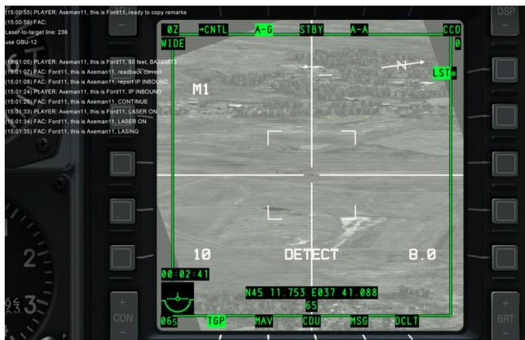
Рис. 246. TGP в режиме поиска лазерного пятна.
