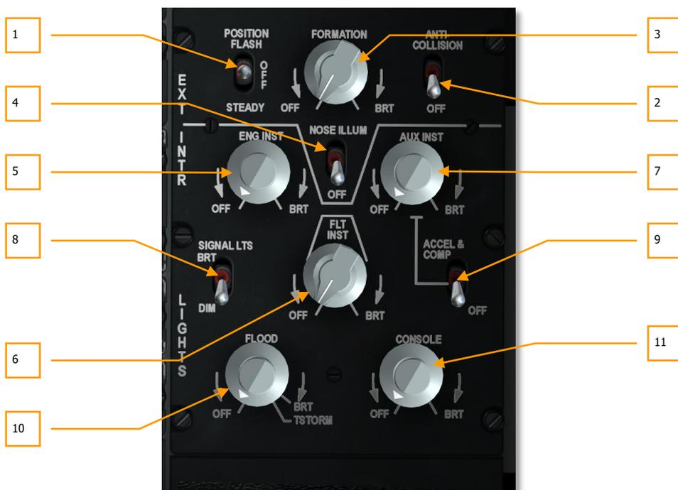
**Рис. 126. Панель управления освещением.**
