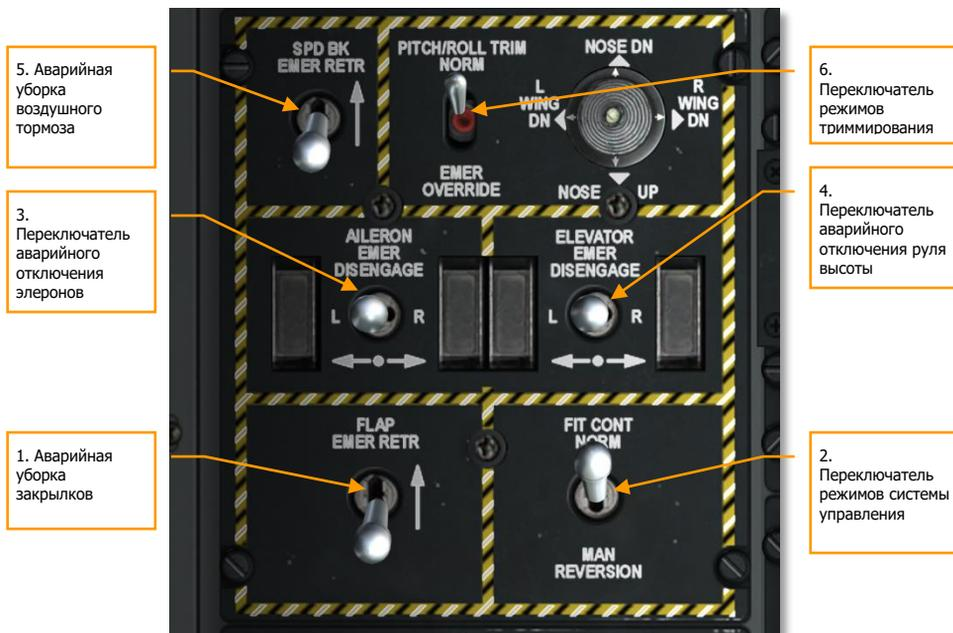
**Рис. 298. Панель аварийной системы управления самолетом.**
