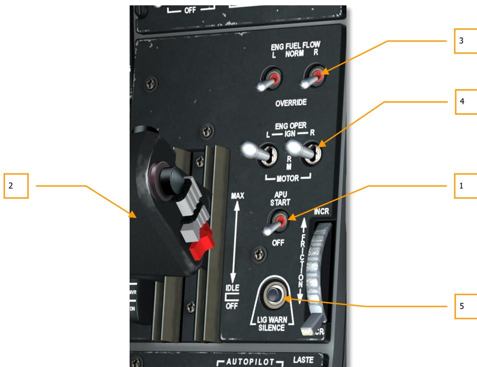
**Рис. 108. Панель управления двигателями.**
