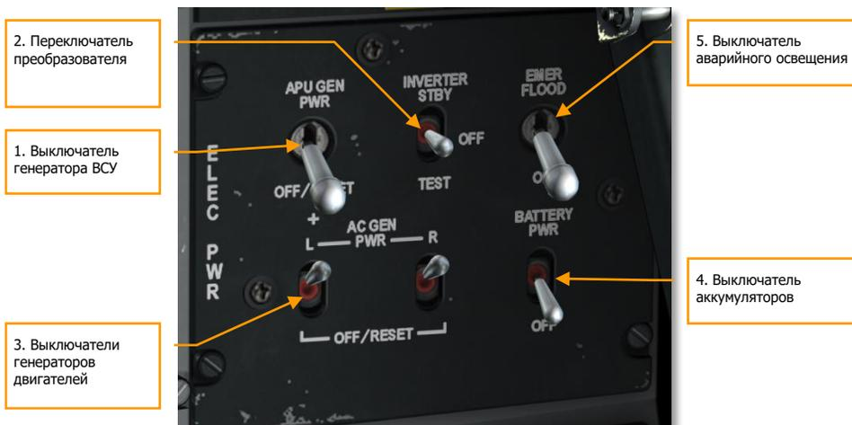
**Рис. 305. Панель управления электропитанием.**
