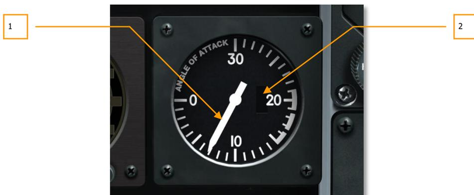
**Рис. 77. Указатель угла атаки.**
