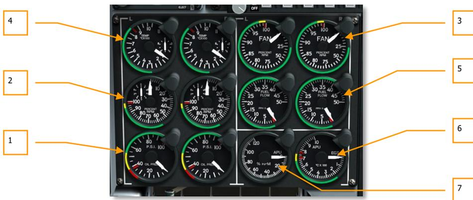
**Рис. 100. Приборы контроля состояния двигателей.**
