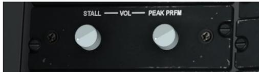
**Рис. 121. Панель управления системой предупреждения о сваливании.**
