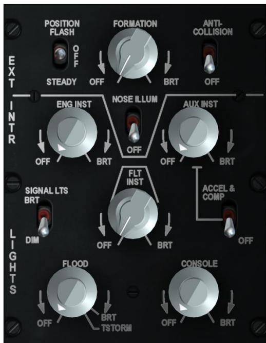
**Рис. 310.** Панель управления освещением.
