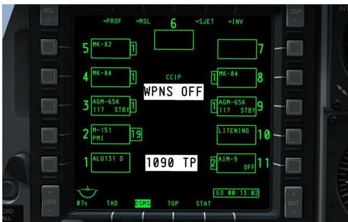
**Рис. 211. Активный профиль Weapons Off, главный выключатель вооружения в положении SAFE.**
