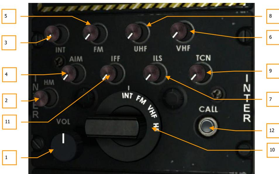
**Рис. 120. Панель управления переговорным устройством.**
