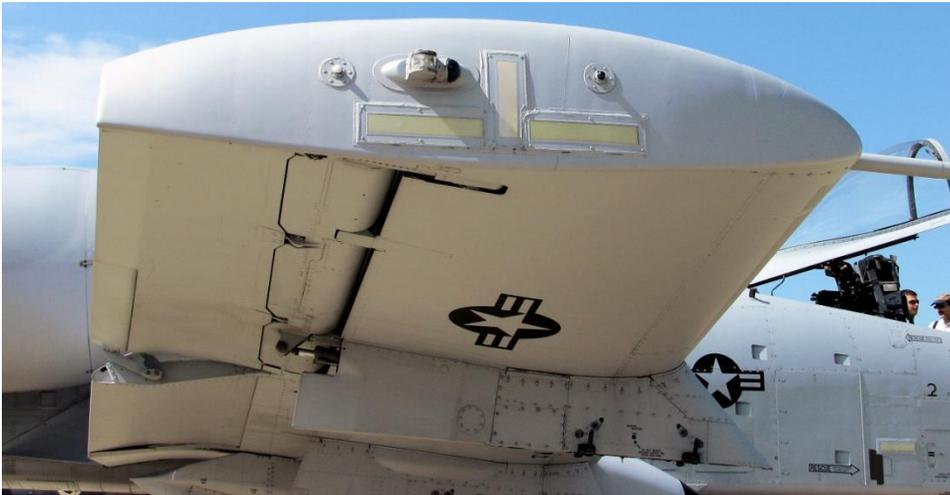
**Рис. 35. Законцовка крыла и элерон.**
