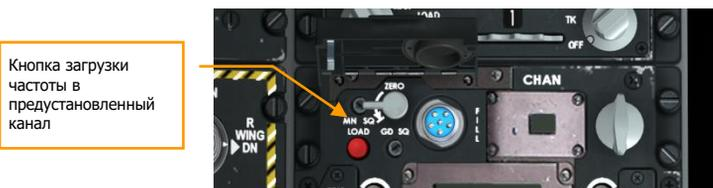
Рис. 112. Кнопка загрузки частоты в предустановленный канал.
