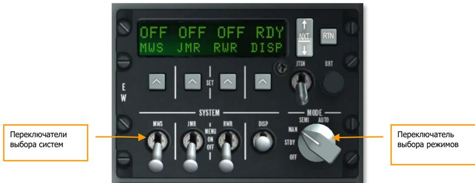
**Рис. 389.** Панель управления системой противодействия.
