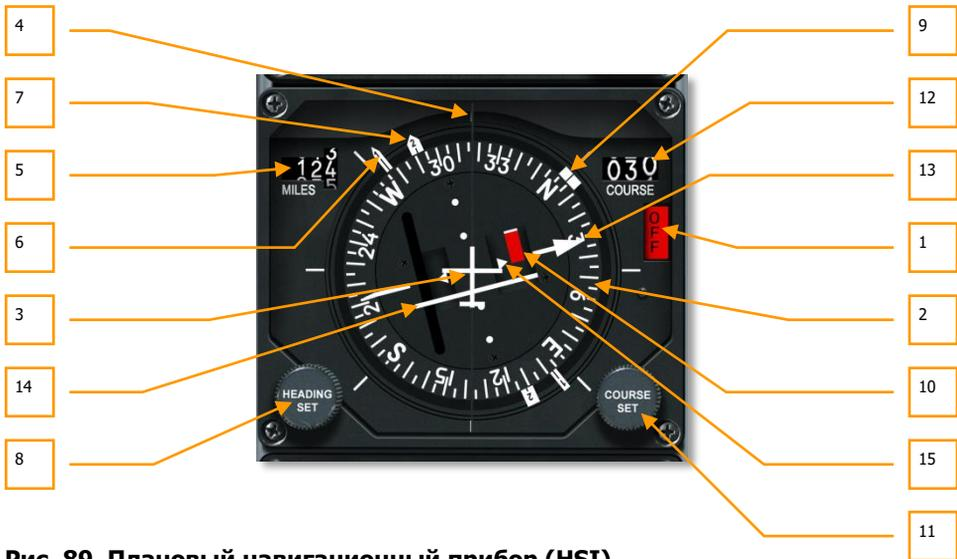
**Рис. 89. Плановый навигационный прибор (HSI)**
