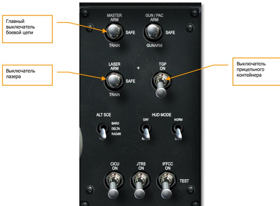
**Рис. 438. Панель системы управления вооружением.**
