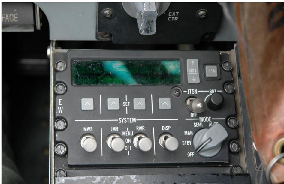
**Рис. 39. Панель управления системой противодействия (CMSP).**
